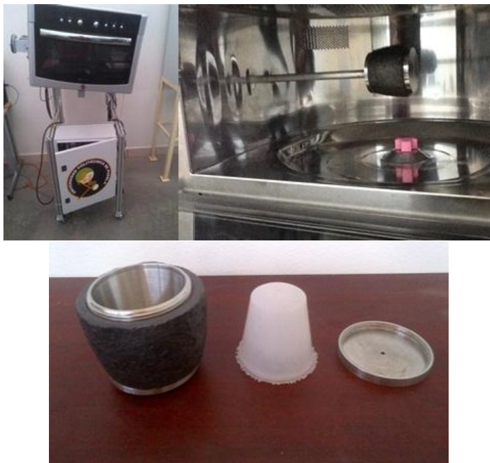
Figura 7. Dispositivo mecatrónico de calentamiento volumétrico por microondas y el producto plástico de prueba terminado.
