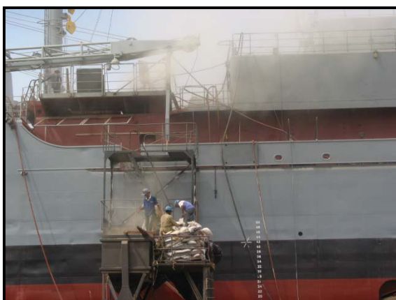
Ilustración 1. Trabajos de Sandblasting en COTECMAR
