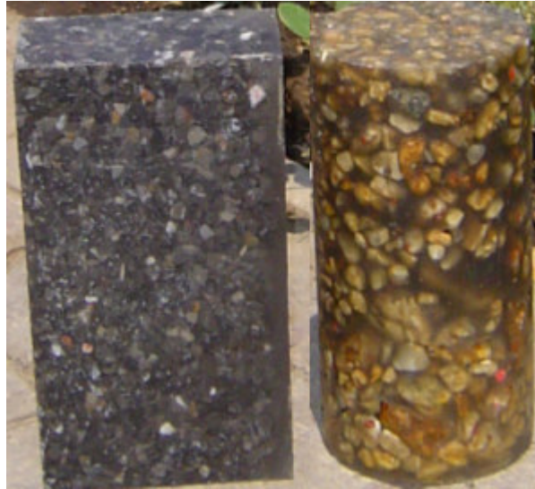
Figura 5. Muestras de variantes de concreto translúcido combinado con distintos tipos de grava.
