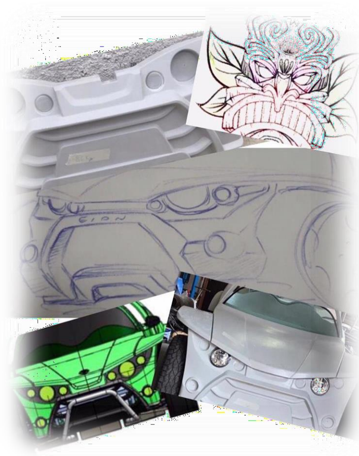
Figura 03 – Inspiração da Carranca Tiki, Primeiro Desenho, Modelo 3D, Primeira Fibra de Vidro e o Protótipo Beta do Buggy Power, da startup EION.
