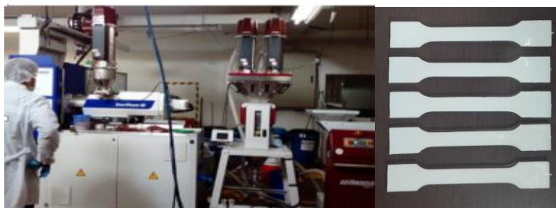
2.figura: Proceso de inyección
