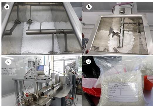
1.figura: Proceso de extrusión - Pelitizado
