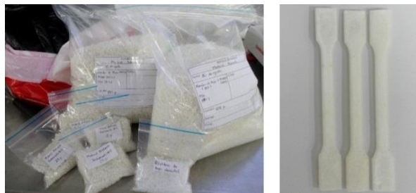
Figura 5: Productos finales pellets y probetas tipo corbatín
