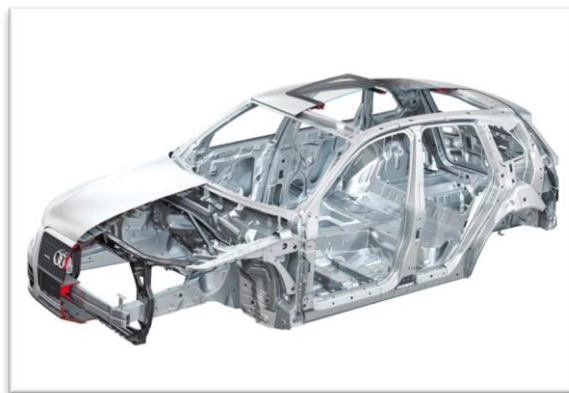
Figura 3. Carrocería de chasis Auto portante(Monocasco)
