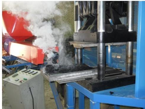
Luego la teja se retira del molde y se enfría en un bastidor especial durante 10 minutos. (Figuras 5 y 6).
